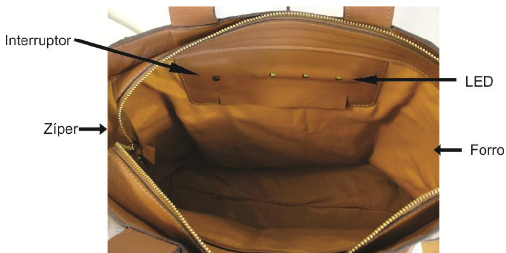
Figura 22: Representação do LED e seu circuito no interior da bolsa.
